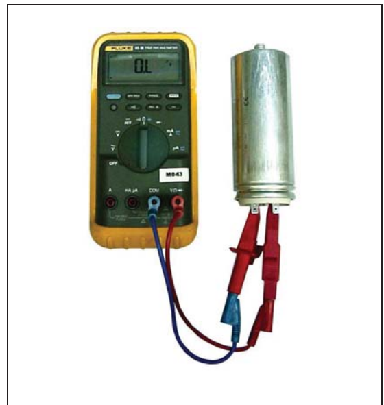
Fig. E.4.1-1: Checking capacitors
