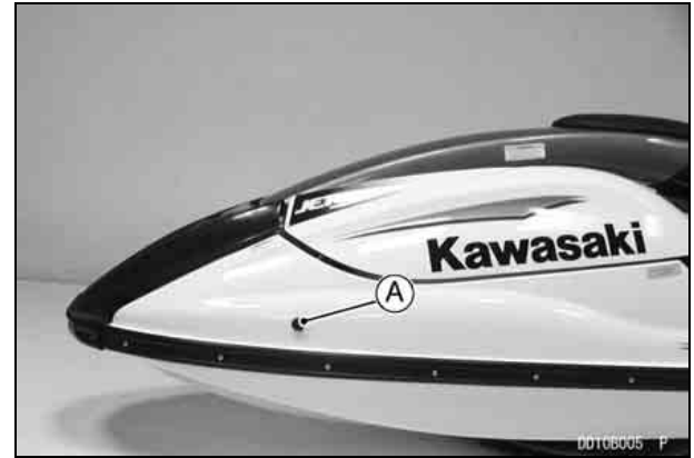
A. Bypass Outlet
