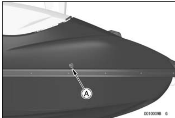
A. Bypass Outlet
