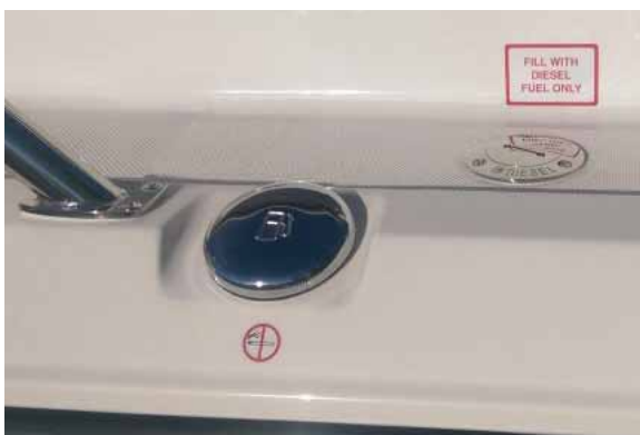
EPA Fuel Fill & Diesel Fill
