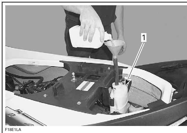
1. Pour antifreeze/water mix in expansion tank
