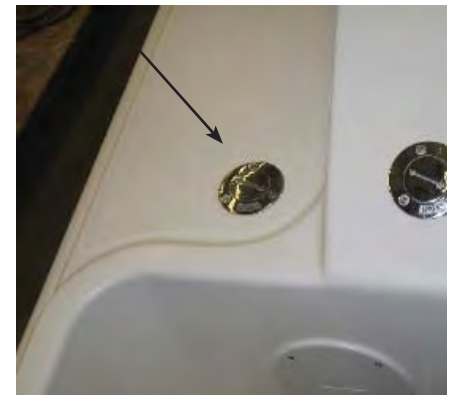
Port Side Fuel Fill
