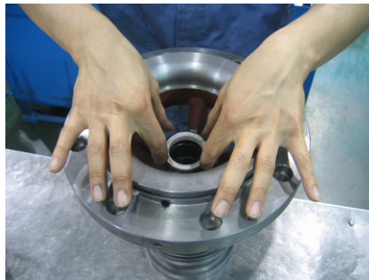
Fig.4 Assembly of seat ring of mechanical seal (메카니칼 셀의 시트링 조립)
