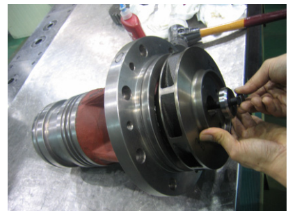
Fig.8 Assembly of impeller and bolt & washer (임펠러, 볼트 그리고 와셔의 조립)
