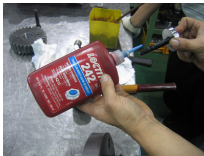
Fig.8 Assembly of impeller and bolt & washer (임펠러, 볼트 그리고 와셔의 조립)
