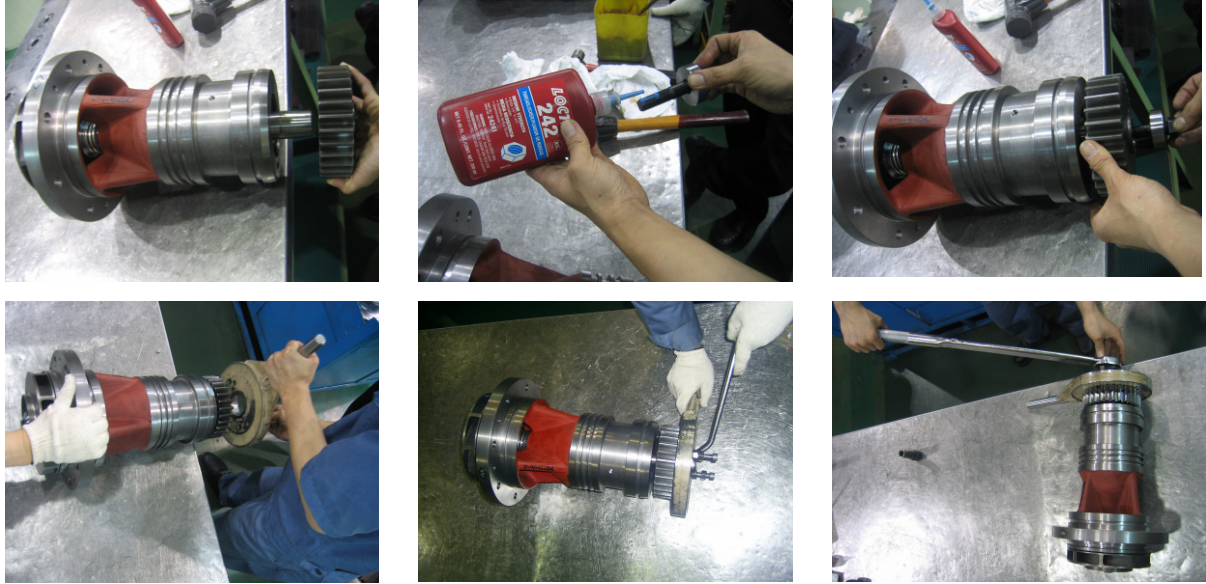
Fig.9 Assembly of spur gear and bolt & washer (스퍼 기어, 볼트 그리고 와셔의 조립)
