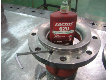
Fig.3 Plugging with Loctite 620 (록타이트 620 도포후 플러깅)
