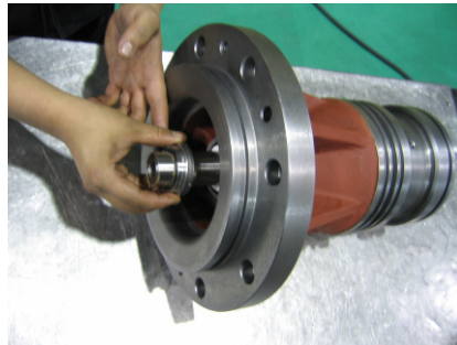
Fig.7 Assembly of rotating part (회전체의 조립)
