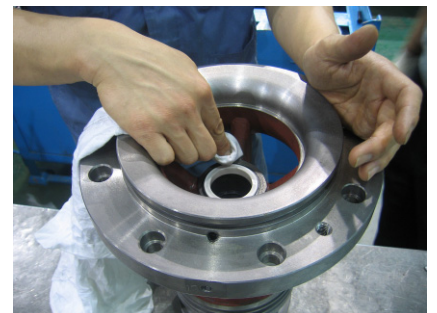
Fig.4 Assembly of seat ring of mechanical seal (메카니칼 셀의 시트링 조립)
